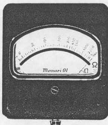
**Meßbereich:** 1 bis 10 000  $\Omega$  <sup>\*)</sup>.**Meßgenauigkeit:** etwa  $\pm 3\%$ .**Ablesegenauigkeit:** etwa  $\pm 3\%$ .**Kurzschlußstrom:** 10 mA.**Stromquelle:** eingebaute 1,5-V-Batterie.**Abmessungen:** 70  $\times$  70  $\times$  30 mm.**Gewicht:** etwa 0,5 kg.**Ersatzgeräte:** Leitungsprüfer LMP 2 (Siemens & Halske).
